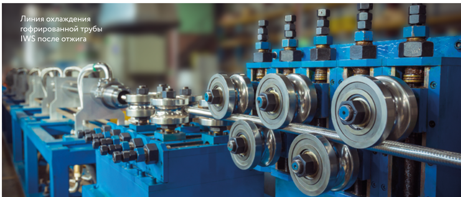
Контроль процесса отжига гофрированной трубы IWS
